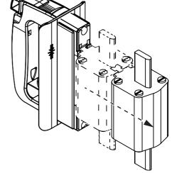
Immer beide Grifflaschen in die Grifflaschenaufnahme einsetzen.
